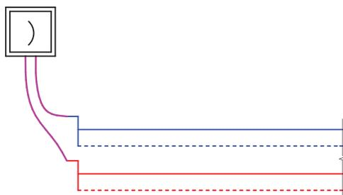
Электрическая схема закольцовки двухтрубной СОДК (IP 67)
